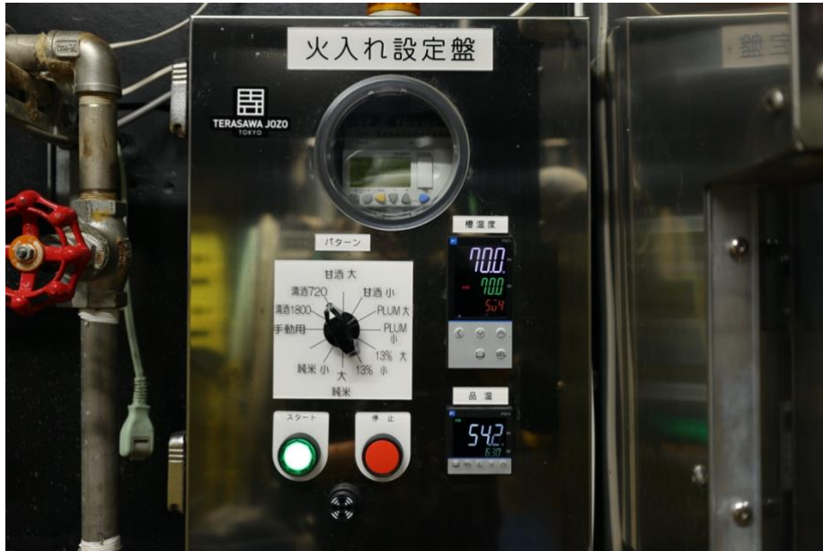
火入れ殺菌装置「瓶爛システム」：設定盤
