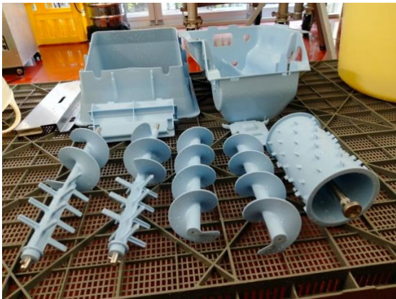
「吟醸型切返し機」：取り外して洗浄できるパーツ類
